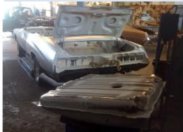
Opravená nádrž před umístěním do auta
