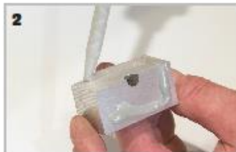
Obr.2 Nanášení Metallklebru Stahl Rapid
