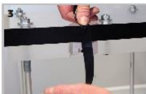
Obr.3 Připevnění nástavce lepicí páskou, aby se zabránilo sklouznutí
